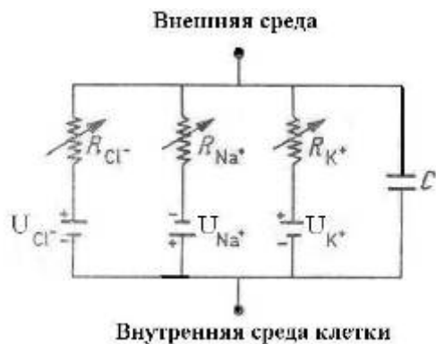
Рис 2. Эквивалентная электрическая модель мембраны нерва: батареи создают суммарный мембраны потенциал U , ионная проводимость обозначена сопротивлениями R , емкость мембраны – конденсатор C [12].
