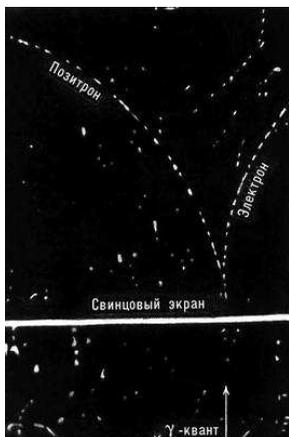
Рис. 3.7. Образование пары позитрон-электрон в камере Вильсона. Видны следы позитрона и электрона, образовавшихся при взаимодействии  $\gamma$ -кванта с ядром свинца в свинцовом экране, перегораживающем камеру. Иллюстрация взята из БСЭ.
