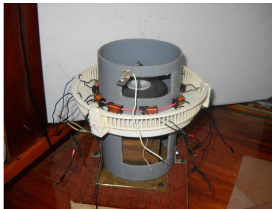
Фото 1. Экспериментальная установка по изучению явлений, возникающих при вращении магнитного поля (вектора магнитной индукции).
