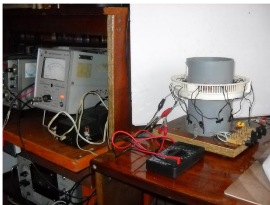
Фото 2. Измерение параметров электрического тока и поля при вращении кольцевого магнита.
