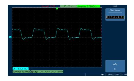
Рисунок 3. Осциллограмма сигнала на выходе кварцевого генератора DD1
