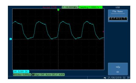
Рисунок 4. Осциллограмма сигнала на выходе инвертора DD2
