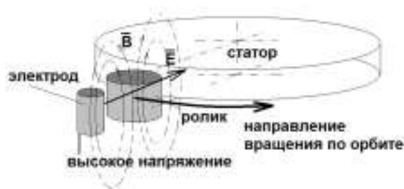
Рис. 6 Схема скрещенных электрических и магнитных полей, предложенная Фроловым А.В.
