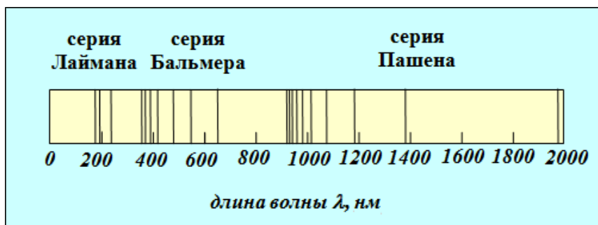
Рис.4. Длинны волн, излучаемые атомом водорода: спектр состоит из серий (показаны только три первые серии) — последовательностей линий, сгущающихся к некоторому (своему для каждой серии) предельному минимальному значению. Только четыре линии серии Бальмера лежат в видимом диапазоне.
