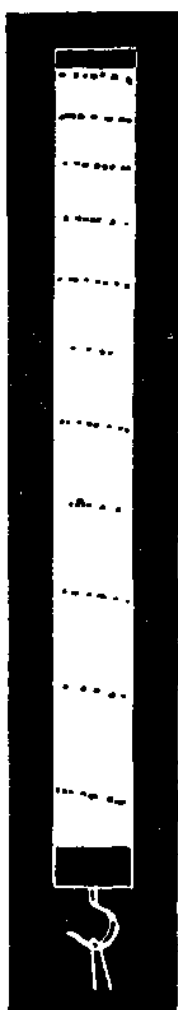
Рис. 24. Падающее тело с отметками времени и их обработка с обычными ошибками опыта и отсчета. Этот опыт показывает прежде всего, что измерение второй производной — дело довольно неприятное, пока не применяется фотографическая регистрация.
