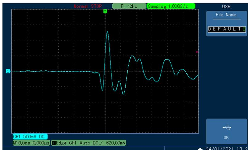
Рисунок 5. Форма сигнала на выходе проволочной рамки
