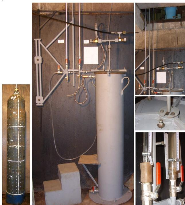
Рисунок - Принципиальная схема и фото установки: «Водяная рубашка», реализованной в ИЭС им. Е. О. Патона, для испытаний баллонов на остаточное расширение.
