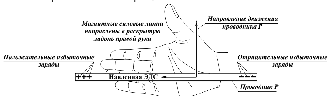
Рис. 2. Определение направления ЭДС, наведенной в проводнике P
