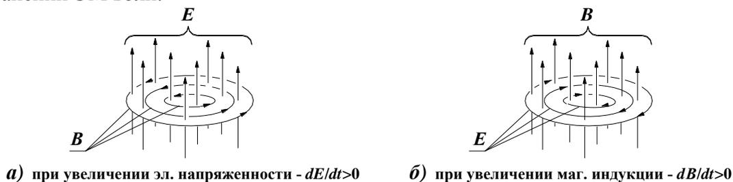
**Рис. 5.** Взаимные преобразования электрических и магнитных полей
