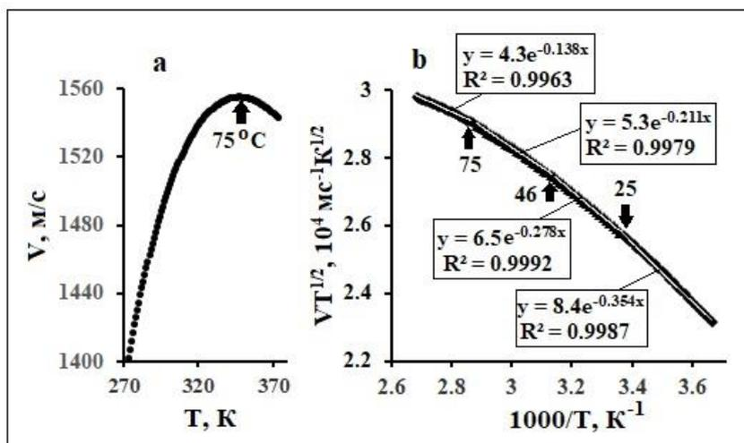
**Рис. 9.** Зависимость скорости звука в воде ( $V$ ) от  $T$  (a) и ее аппроксимации(b).
