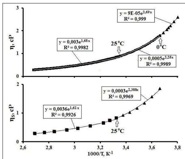
Рис. 3.  $f_a$ -Аппроксимации ТЗ динамической ( $\eta$ ) и сдвиговой вязкости воды ( $\eta_s$ ). Данные по  $\eta(T)$  и  $\eta_s(T)$  взяты из [15, 16], соответственно. Линии трендов бесцветны и прерывисты.
