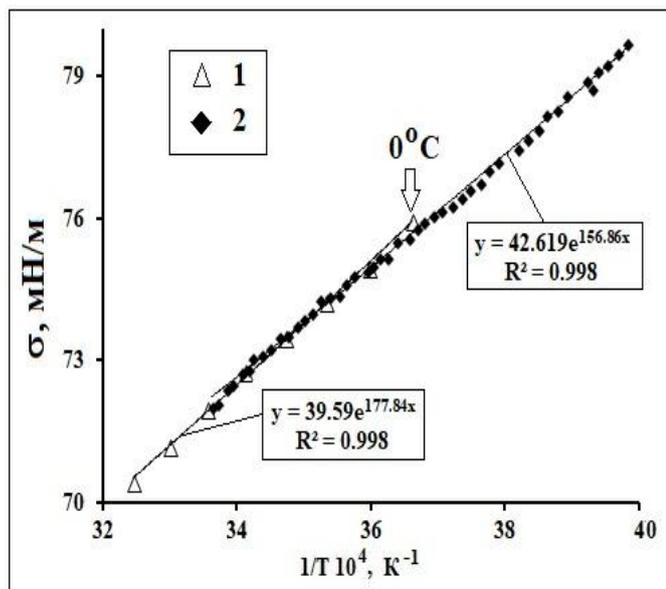
**Рис. 11.** Аппроксимации ТЗ коэффициента поверхностного натяжения ( $\sigma$ ).
