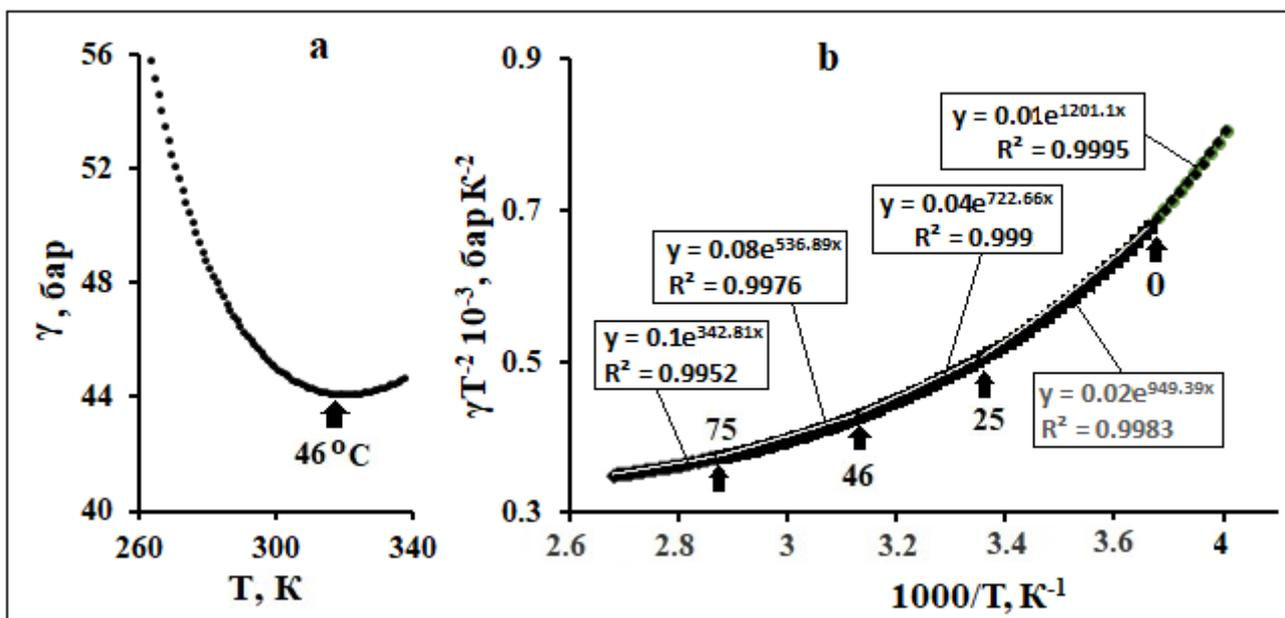
**Рис. 10.** Зависимость сжимаемости воды ( $\gamma$ ) от  $T$  (a) и ее  $f_a$ -аппроксимации(b).
