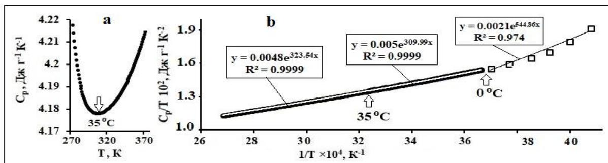
**Рис. 7.** Температурная зависимость теплоемкости воды ( $C_p$ ) от  $T$  (а) и ее  $f_a$ -аппроксимации(б). для  $T > 273 \text{ К}$  из [17], а для  $T < 273 \text{ К}$  получены оцифровыванием графика  $C_p(T)$  из [18]. Линии трендов бесцветны.
