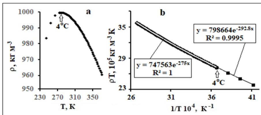
**Рис. 8.** Температурная зависимость плотности воды ( $\rho$ ) от  $T$  (а) и ее  $f_a$ -аппроксимации(б). Данные по  $\rho(T)$  для  $T > 273 \text{ К}$  из [15], а для  $T < 273 \text{ К}$  получены из графика  $\rho(T)$  из [18].
