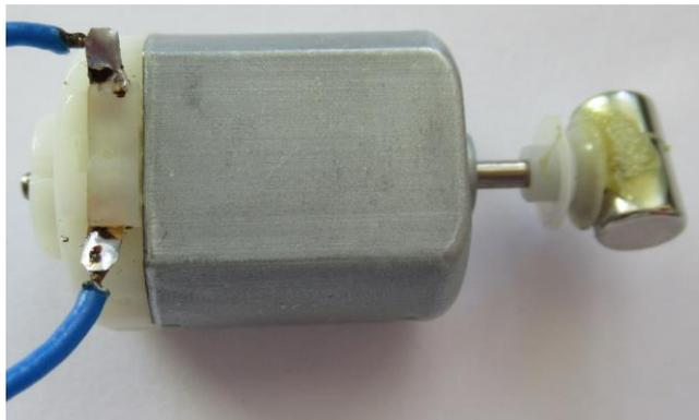
Рисунок 3. Шкив, насаженный на вал двигателя
