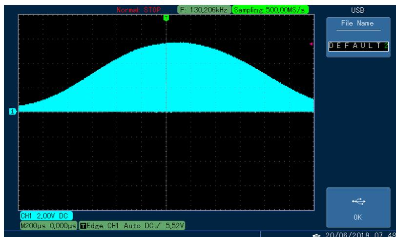
Рисунок 5. Амплитудно-импульсная модуляция сигнала на выходе мультиплексора
