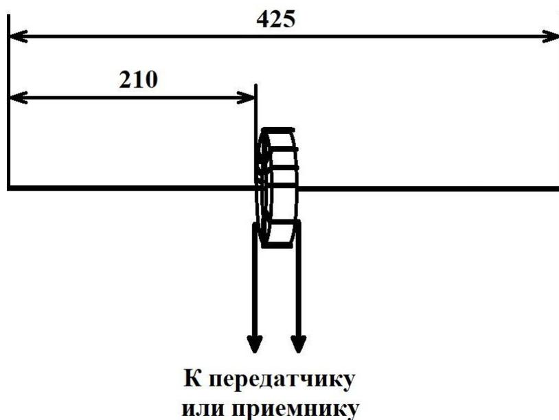
Рисунок 2. Укороченный вибратор на основе ферритового кольца
